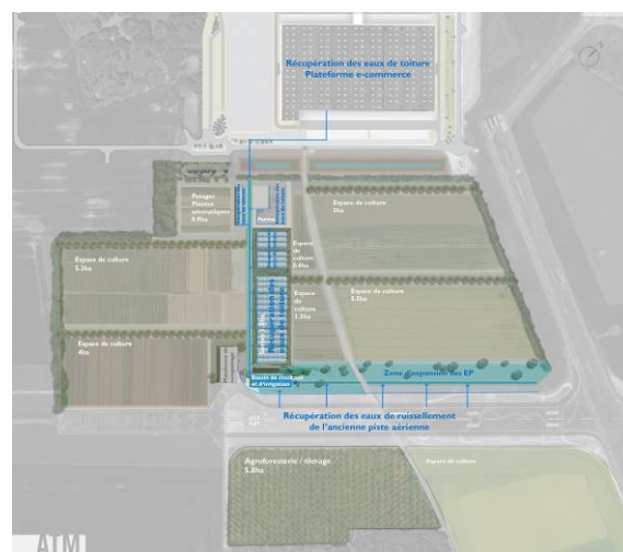
Récupération des eaux pluviales des 4 vastes emprises imperméabilisées pour subvenir aux besoins en eaux de la ferme – © ATM
