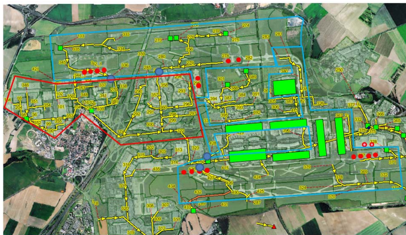
Modèle hydrologique et hydraulique de la plateforme aéroportuaire Paris CDG
